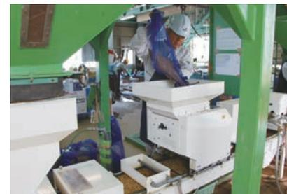
(株)比企アグリサービスの社員が全自動播種プラントにて床土、種もみ、覆土を供給し一連の作業を行います。組合員の田植えの時期に合わせて計画的に温湯消毒、播種作業を行い、組合員に良質な苗を供給できるよう徹底した品質管理を行っています。
